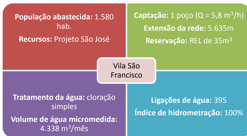
Figura 7.87 –Dados sobre o abastecimento de água da localidade de Vila São Francisco, no município do Crato, de responsabilidade do SISAR.
