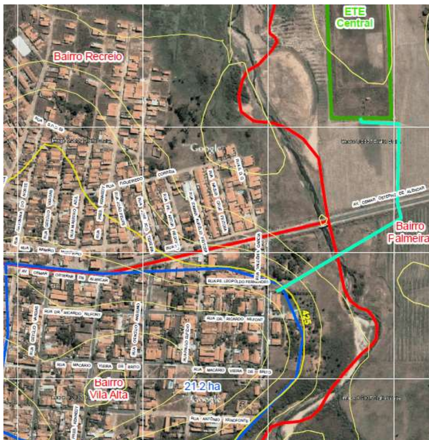
Figura 7.107 – Delimitação da bacia de esgotamento sanitário da ETE Central, no Bairro Vila Alta, sede do Crato, de responsabilidade da SAAEC.
